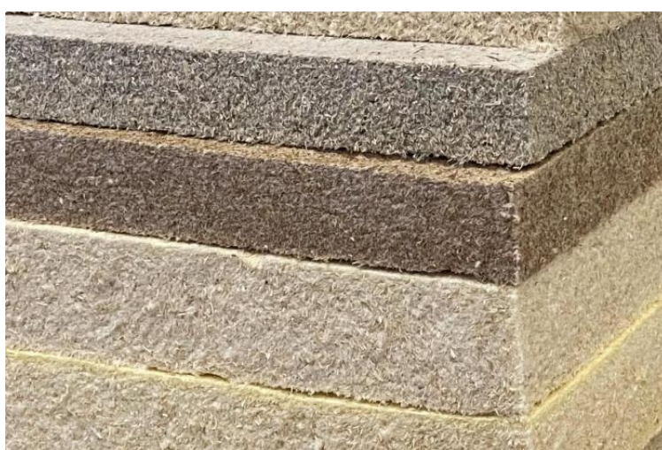
图 8 创新企业 Fiberwood 生产的基于木纤维的隔热材料
